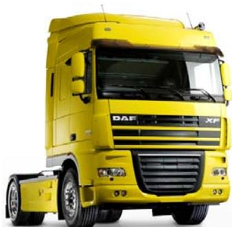
Space Cab и Super Space Cab автомобилей серии XF105 включают фиксированные спойлеры крыши или спойлеры крыши с регулируемой высотой, а также боковые обтекатели кабины. Боковые обтекатели шасси для моделей тягачей могут дополнять аэродинамический комплект.
